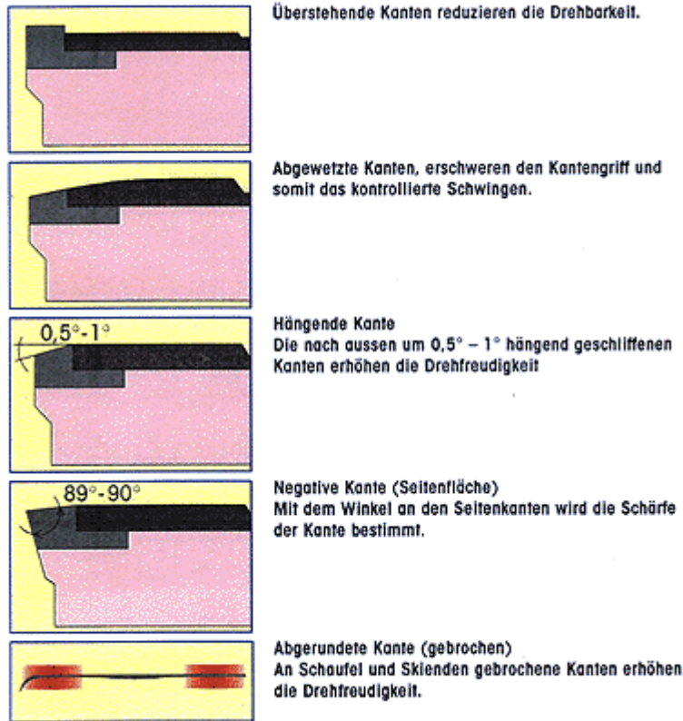
Abb. 25: Richtiges Kantentuning (Quelle: Firma Toko)
