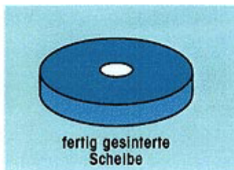
Abb. 22: Verfahren zur Herstellung von Polyäthylbelägen (Quelle: Firma Toko)
