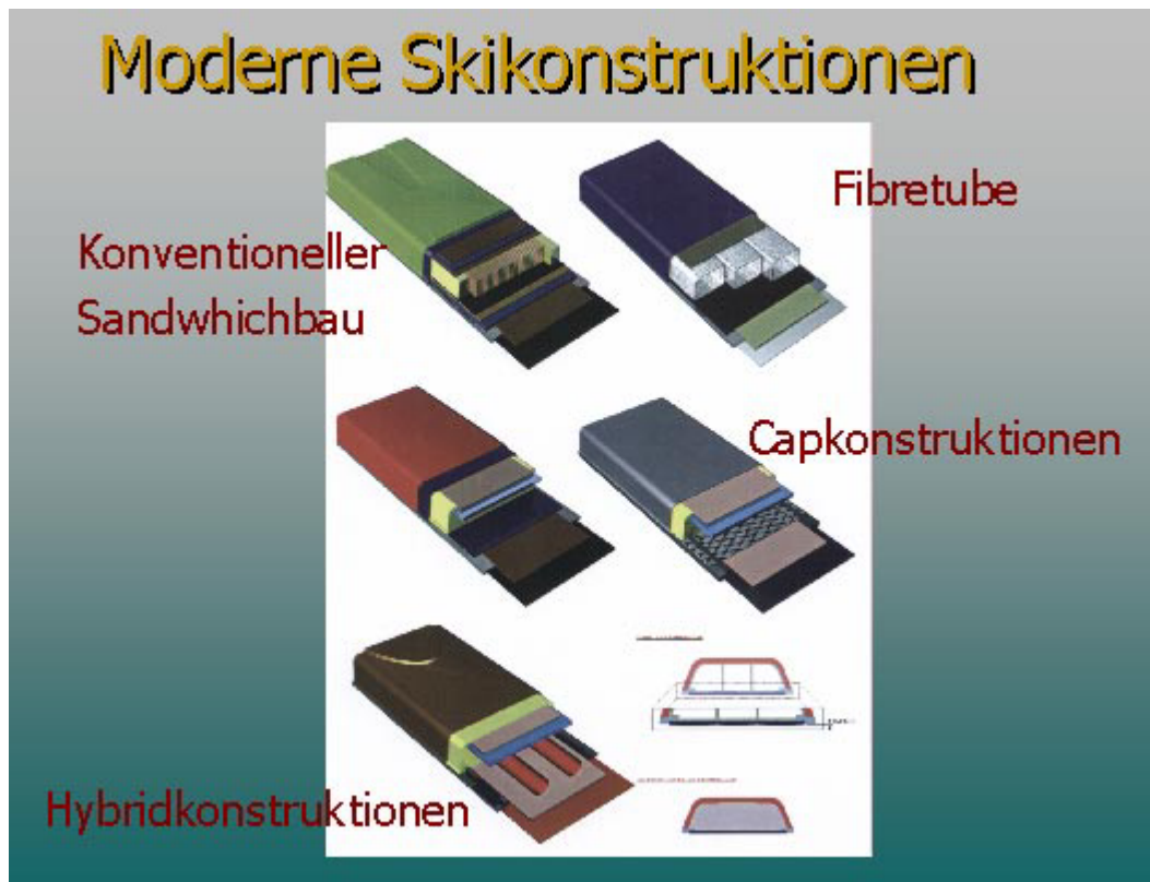
Moderne Skikonstruktionen (schematische Darstellung)
